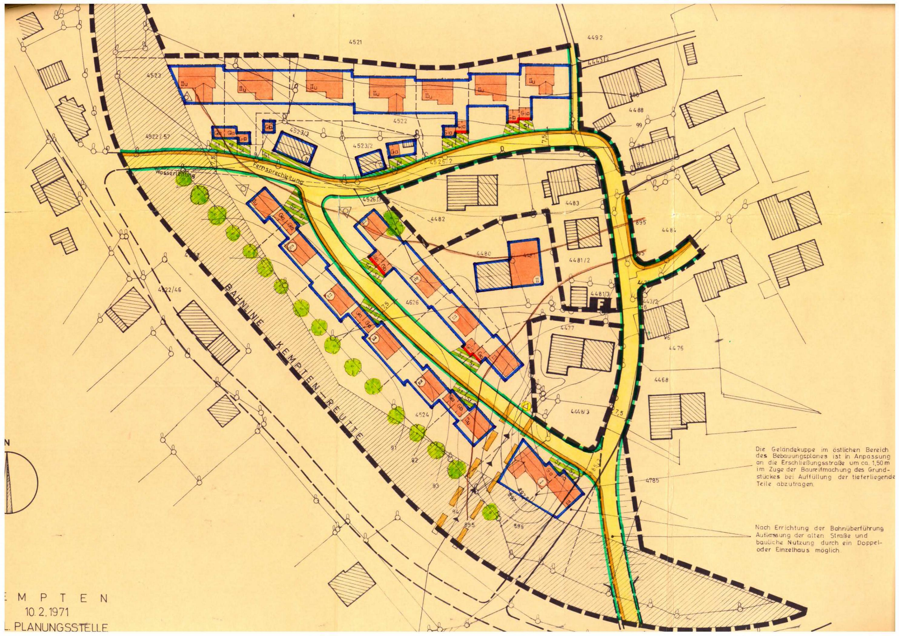
Die Geländekuppe im östlichen Bereich des Bebauungsplanes ist in Anpassung an die Erschließungsstraße um ca. 1,50 m im Zuge der Baureifmachung des Grundstückes bei Auffüllung der tieferliegenden Teile abzutragen.
